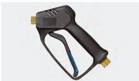
Professionelle Pistole. Weepausführung. Max. 210 bar / 25 l/min / 150 °C
