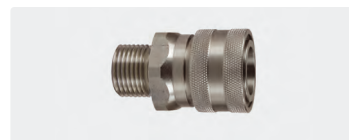
Kupplung : AG. Edelstahl. 60° Dicht- konus. Max. 250 bar / 150 °C
