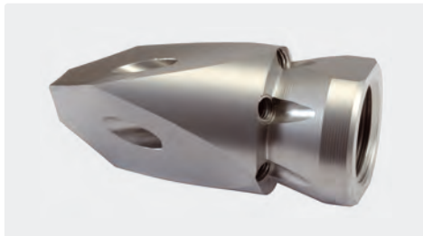
300 bar. 1/2" IG. \square 68 mm, \varnothing = 31 mm, \boxtimes 0,17 kg. Für Rohre > 60 mm. Seitliche Frontstrahlen mit gehärteten Edelstahl Düseneinsätzen.
