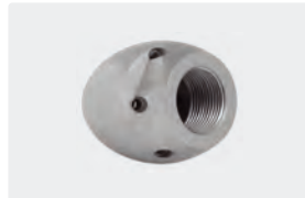
1/2" IG. 6x 75° +1x 0°. 30-100 l/min. Für \text{R} \text{Ø} 100-200 mm. Außen \text{Ø} 40 mm. \text{Ø} 281 g.
