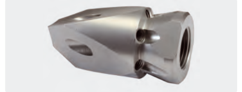
300 bar. 3/8" IG. \square 55 mm, \varnothing = 28 mm, \boxtimes 0,13 kg. Für Rohre > 50 mm. Seitliche Frontstrahlen mit gehärteten Edelstahl Düseneinsätzen.
