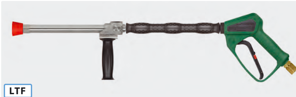
1/2" IG. Edelstahl. Weitwurflanze 350 mm mit Isolierung ST-29 Cool & Compact 330 mm, Pistole easyfarm365+, seitlichem Handgriff und Düsenschutz aus Kunststoff ohne Düse. Max. 250 bar / 60 l/min / 100 °C
