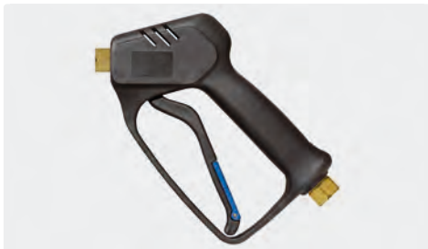
Professionelle Pistole. Weepausführung. Max. 210 bar / 25 l/min / 150 °C
