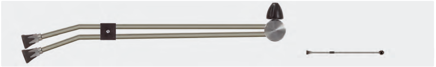
1/4" IG. Strahlrohr mit Ventil ST-53.2 oben und Düsenschutz ST-10 mit Niederdruckdüse. Max. 400 bar / 150 °C
