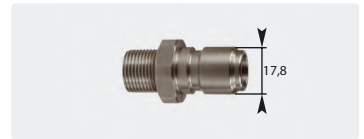
Stecknippel : AG. Edelstahl. 60° Dicht- konus. Max. 250 bar / 150 °C
