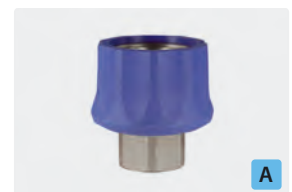
Kupplung : IG. Messing vernickelt. Max. 250 bar / 150 °C
