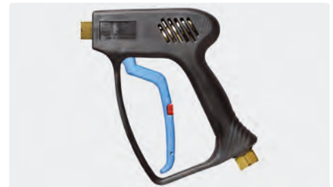
Professionelle Pistole. Frostschutzausführung. Max. 275 bar / 45 l/min / 150 °C
