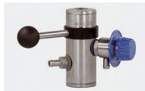
1/2" IG : 1/2" IG. Injektor mit Tülle 9 mm und Druckluftmodul (Tülle 9 mm). Regulierung der Chemiedosierung erfolgt durch 10 auswechselbare Dosiereinsätze (0,5 - 2,0 mm). Max. 350 bar / 100 °C
