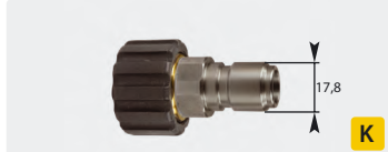
Stecknippel : IG. Edelstahl + Messing. Max. 250 bar / 150 °C
