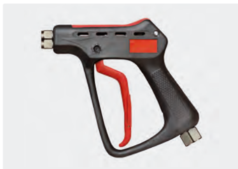
Professionelle Höchstdruckpistole. Max. 600 bar / 80 l/min / 150 °C
