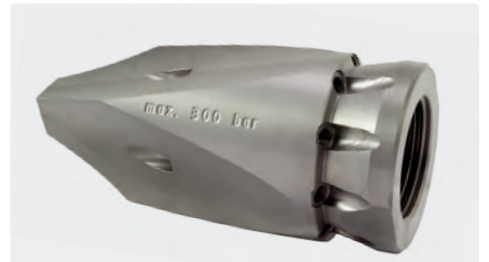
300 bar. 1" IG. \square 100 mm, \varnothing = 50 mm, \boxtimes 0,64 kg. Für Rohre > 100 mm. Seitliche Frontstrahlen mit gehärteten Edelstahl Düseneinsätzen.
