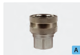
Kupplung : IG. Messing vernickelt. Max. 250 bar / 150 °C
