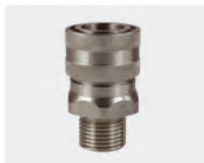
Kupplung : AG. Edelstahl. 60° Dichtkonus. Max. 250 bar / 150 °C
