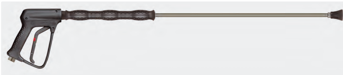
Professionelle Pistole AWT EcoLine No. ONE mit Strahlrohr 900 mm Stahl verzinkt, Isolierung ST-28 Cool & Compact 300 mm und Düsenschutz ST-10 ohne Düse. Max. 250 bar / 45 l/min / 150 °C
