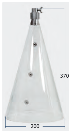
Spritzschutztrichter aus PVC, mit Flügelschraube einstellbare Halterung aus Edelstahl zur Befestigung an Lanzen. Max. 80 °C
