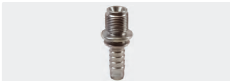
Pressnippel. M7x0,5 AG. DN 4. Edelstahl. Max. 500 bar
