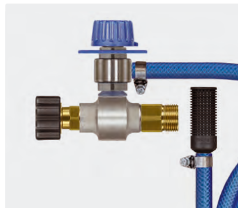
M22 IG : M22 AG. Injektor mit Dosierventil ST-161, Saugschlauch 2.000 mm und Saugfilter ST-31. Max. 350 bar / 90 °C
