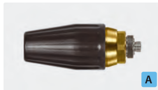
1/8" AG. Spritzwinkel 20°. 100 - 250 bar. Max. 100 °C
