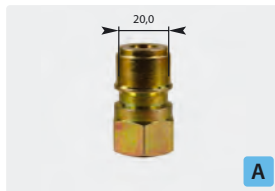
Stecknippel : IG. Stahl verzinkt. Max. 250 bar / 150 °C
