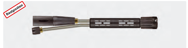
Schaumdoppellanze mit Isolierung ST-9 205 mm, Umschaltventil ST-58, Düsenschutz ohne Mundstück und Schaumkopf ST-75.1 ohne Düse. Es wird ein Schauminjektor benötigt. Max. 350 bar / 45 l/min / 100 °C
