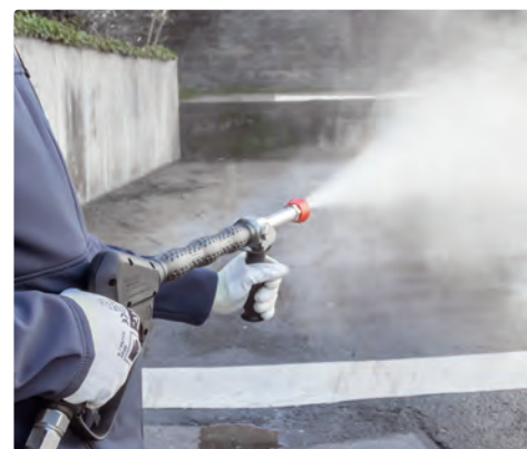
1/4" AG. Edelstahl. Weitwurflanze 350 mm mit Isolierung ST-29 Cool & Compact 330 mm, seitlichem Handgriff und Düsenschutz aus Kunststoff ohne Düse. Max. 280 bar / 130 l/min / 100 °C
