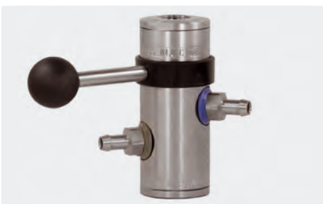
1/2" IG : 1/2" IG. Injektor mit Tülle 9 mm und Druckluftmodul (Tülle 9 mm). Regulierung der Chemiedosierung erfolgt durch 10 auswechselbare Dosiereinsätze (0,5 - 2,0 mm). Max. 350 bar / 100 °C
