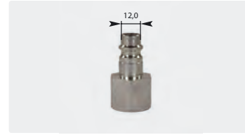
Stecknippel : IG. \varnothing 12 mm. Stahl gehärtet, chemisch vernickelt/ verzinkt. Max. 200 bar / 100 °C
