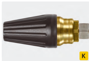
M18 IG. Spritzwinkel 20°. 200 - 400 bar. Max. 100 °C
