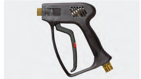
Professionelle Pistole. Max. 275 bar / 45 l/min / 150 °C
